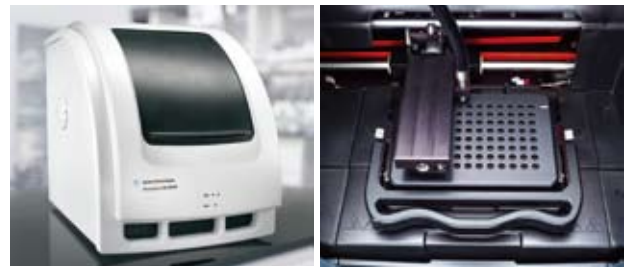
図4 Mx3005P リアルタイム PCR システム（左）とそのスキャンシステム（右）
